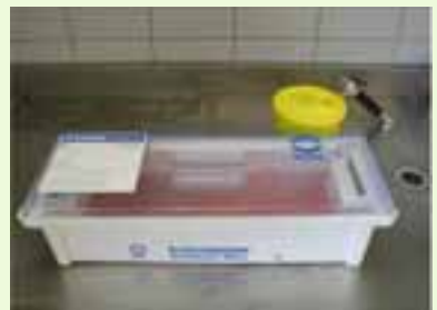
Desinfektionsbad für Arbeitsmittel
